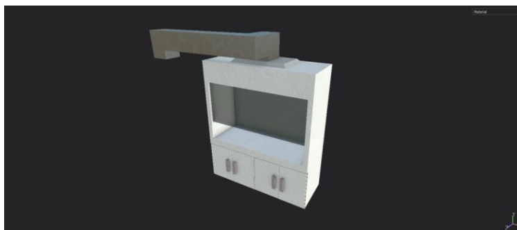
Figura 28 - Capela de química
